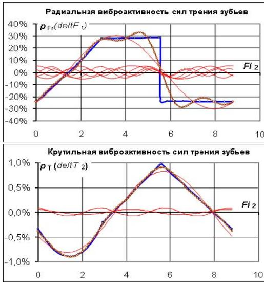
Рисунок 6 – Гармонический анализ виброактивности типичной передачи
