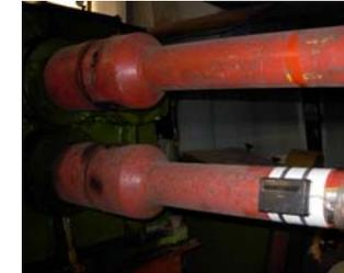
Рисунок 10 – Телеметрический измеритель моментов, установленный на нижнем шпинделе прокатного стана
