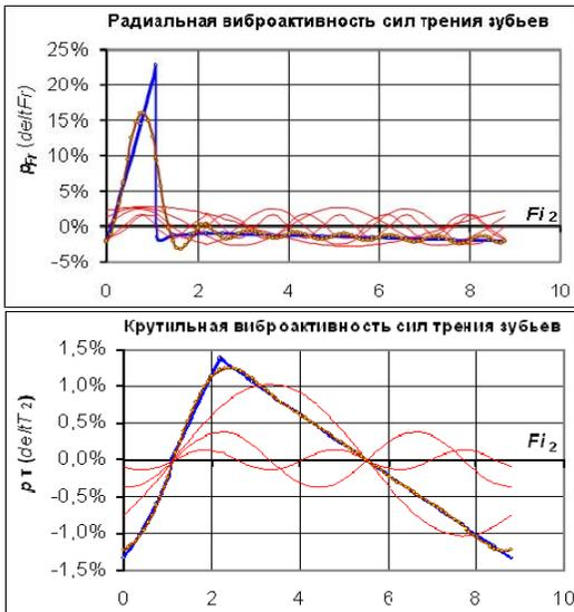
Рисунок 7 – Гармонический анализ виброактивности в почти заплюзной передаче
