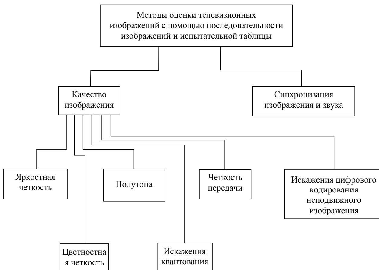
Рис. 3. Методы оценки телевизионных изображений с помощью последовательности изображений и испытательной таблицы
