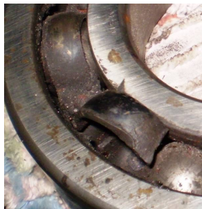
Рис. 2 Цвета побежалости на сепараторе разрушенного подшипника
