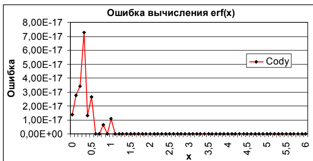
Рис. 2. Погрешность вычислений функции ошибок: а) для типа float; б) для типа long double
