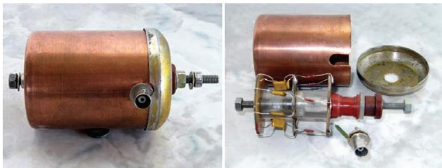
*а* – общий вид емкости; *б* – емкость в разобранном виде
