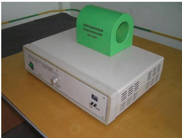
Рисунок 3 – Общий вид генератора ИГЛА-МВ-10 МГц с ИТ-75/170
