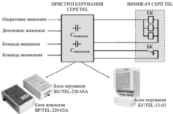
Рис. 2. Схема керування вимикачем серії TEL.
