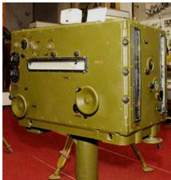
Рис. 6. Прилад управління артилерійсько-зенітним вогнем М. Г. Бруєвича
