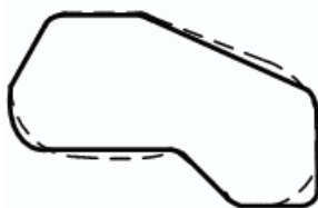
Рисунок 10 – Контур исходного и нового отверстия ребра
