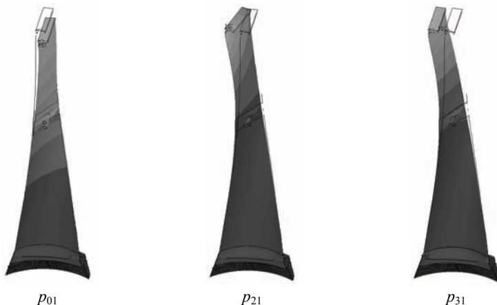
Рисунок 5 – Формы колебаний лопаточного аппарата
