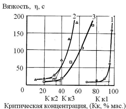
Рис. 2. Зависимость вязкости лакокрасочных составов от концентрации эпоксидной смолы ЭД-20 (1), катионита КУ-2-8чС (2) и двуокиси титана и минерального порошка в соотношении 2 : 3 (3):
