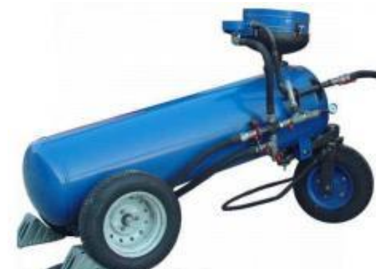
Рисунок 1 – Установка для струйно-абразивной обработки деталей с использованием давления сжатого воздуха до 2 МПа
