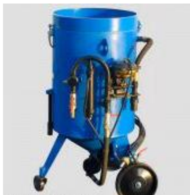
Рисунок 2 – Установка для струйно-абразивной обработки деталей с использованием давления сжатого воздуха до 0,6 МПа
