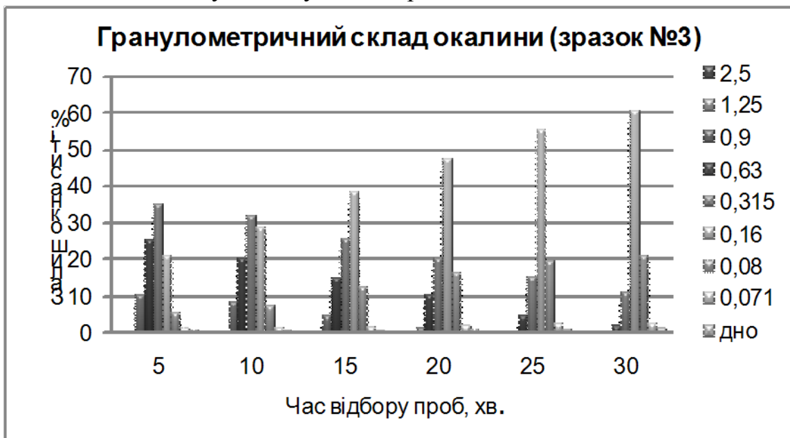
Рис. 4. Гранулометричний склад окалини третього зразка в результаті подрібнення в кульовому млині протягом 30 хвилин
