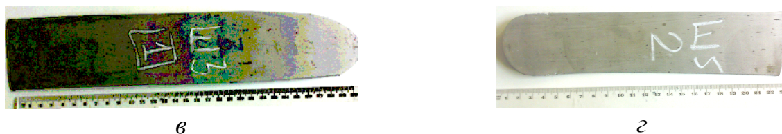
Рис. 2 – Вид образцов после прокатки «а»-«б» – образцы с начальной толщиной 8 и 6 мм, соответственно; «в»-«г» – образцы с начальной толщиной 13 и 11 мм, соответственно
