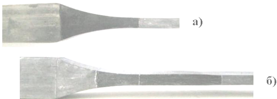
Рисунок 6 - Недокаты: а) – первичный, б) – после поворота на угол \alpha
