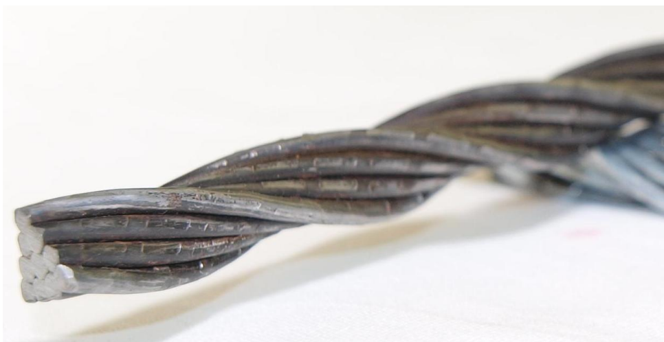
Рис. 1. Внешний вид трехгранного периодического арматурного каната.
