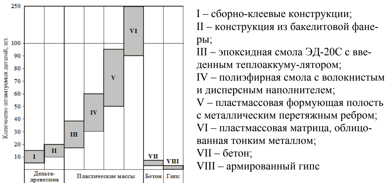
Рис. 4. Максимальная (верхняя граница) и минимальная (нижняя граница) стойкость матриц из различных низкопрочных материалов при пневмоударной штамповке
