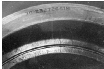
Рис. 2. Изношенный торец борта с трещинами наружного кольца подшипника типа 2726
