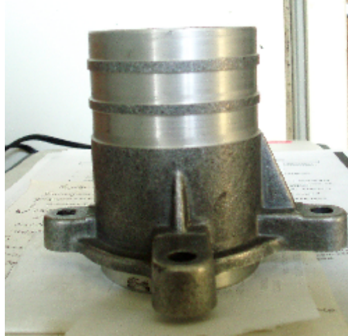
Рис. 1 - Загальний вид вилівка «Корпус помпи»
