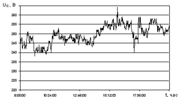
Рис. 4. Изменения напряжения питающей сети в течение рабочего дня
