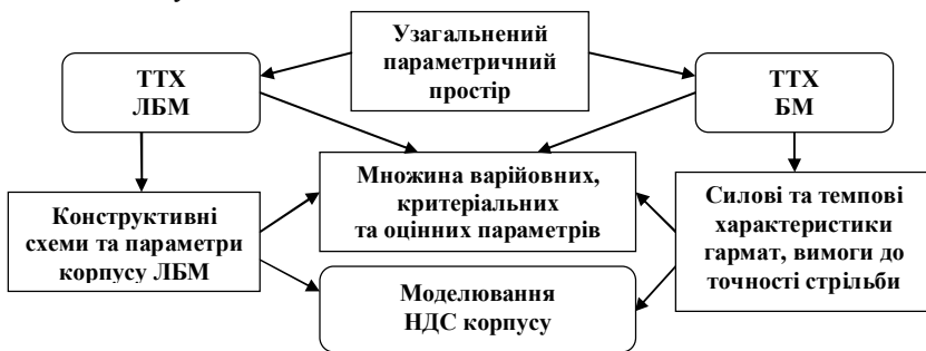
Рисунок 3 – Тактико-технічні характеристики бойової машини в системі формування оціночних критеріїв конструкції корпусу легкоброньованої машини і характеристик бойового модуля
