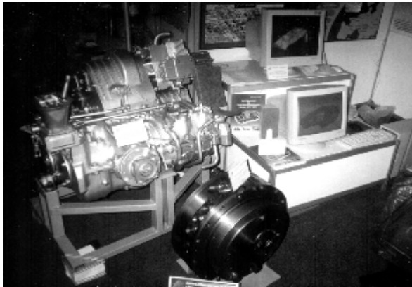
Рисунок 3 – Зразки гідрооб'ємно-механічних трансмісій, розроблених кафедрою спільно з ОАО „ХТЗ ім. С. Орджонікідзе” і ДП завод ім. Малишева
