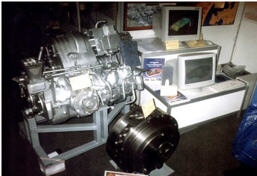
Образцы гидрообъемно-механических трансмиссий, разработанных кафедрой совместно с ОАО „ХТЗ им. С. Орджоникидзе” и ГП завод им. Малышева.
