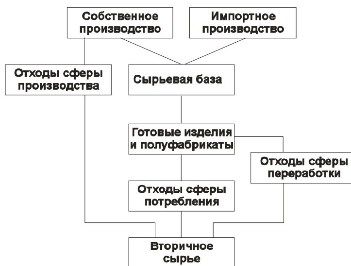
Рис. 1. Функциональная схема образования вторичного сырья
