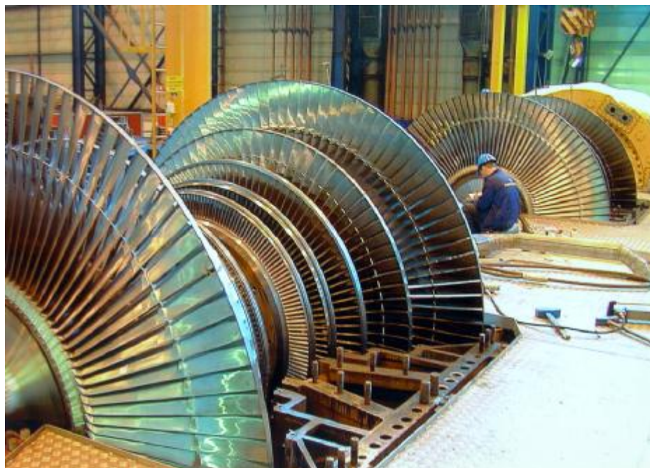
Рис. 2. Модернизированный ротор низкого давления турбины К-220-44
