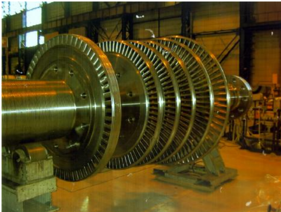
Рис. 1. Модернизированный ротор высокого давления турбины К-220-44
