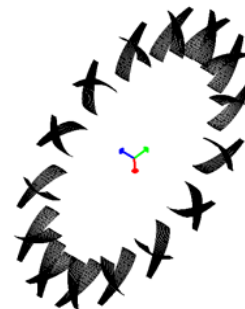
Рисунок 10 – Передняя и тыльная стороны зубьев на цилиндрическом колесе
