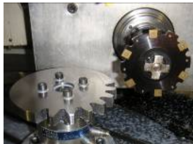
Рисунок 6 – Контурна обробка зубчастого колеса дисковим інструментом
