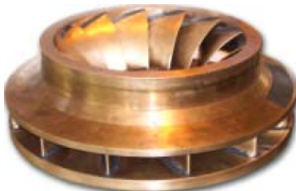
Рис. 7. Модельное рабочее колесо ГТ РО 500-5Вм
