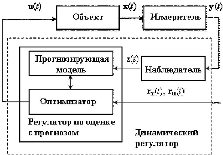
Рис.2. Структурная схема с прогнозированием
