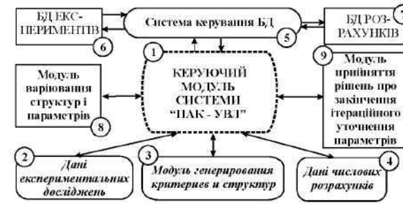
Рис.4. Схема інформаційних потоків в створеному програмно-апаратному комплексі „ПАК – УВЛ”
