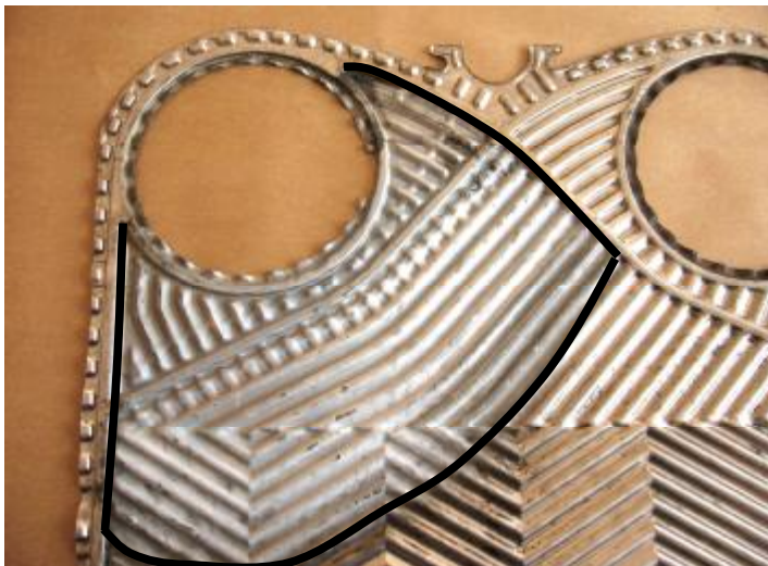
Рис. 1. Интенсивная равномерная коррозия на участке, входа в коллекторное окно пластины теплообменника
