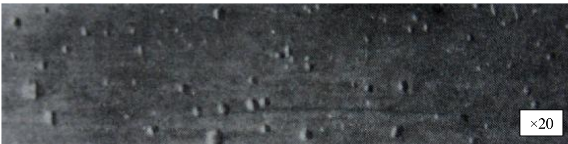
Рис. 1. Внешний вид образца сплава ХН60МБ после промышленных испытаний
