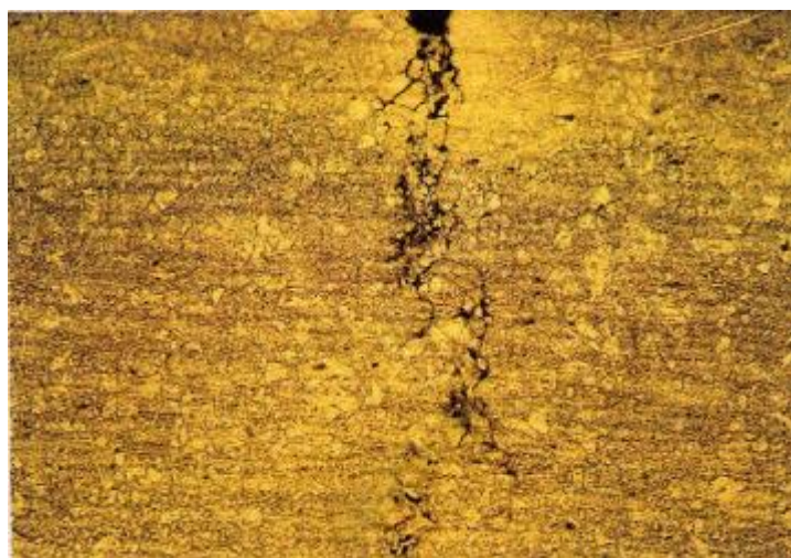
Рис. 4. Трещина в зоне питтинговой коррозии в слое 08X13
