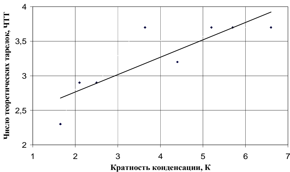
Рис. 5. Зависимость числа теоретических тарелок от кратности конденсации в колонне из трубы \varnothing 70 мм
