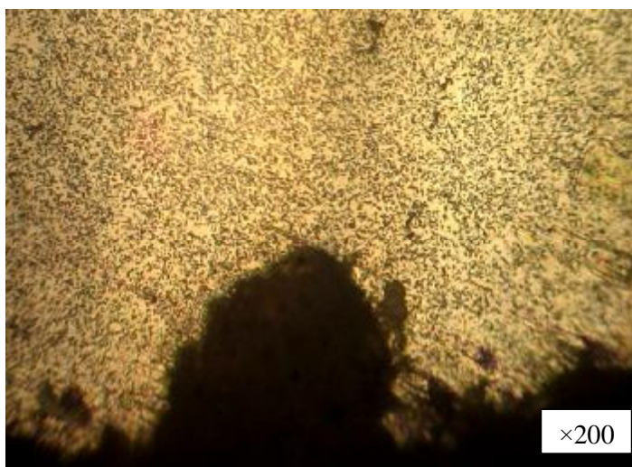
Рис. 3. Интенсивное язвенное разрушение наружной стенки трубы.
