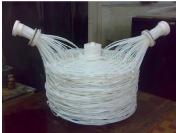
Рис. 4. Фторопластовый теплообменник погружного типа
