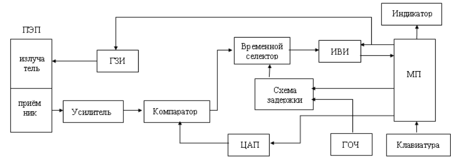
Рис. 3. Структурная схема ультразвукового толщиномера для измерения толщины поверхностного покрытия валков прокатных станов
