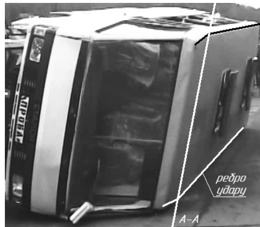
Рисунок 7 - Представлення особливостей сприйняття удару ребром ферми даху
