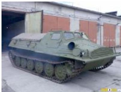
Рисунок 3 – Транспортер-снігоболотохід ГТ-Т
