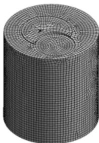
Рисунок 1 – Конечноэлементная модель КС
