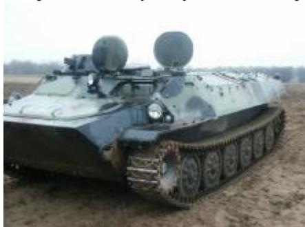
Рисунок 4 – Броньований транспортер-тягач МТ-ЛБ
