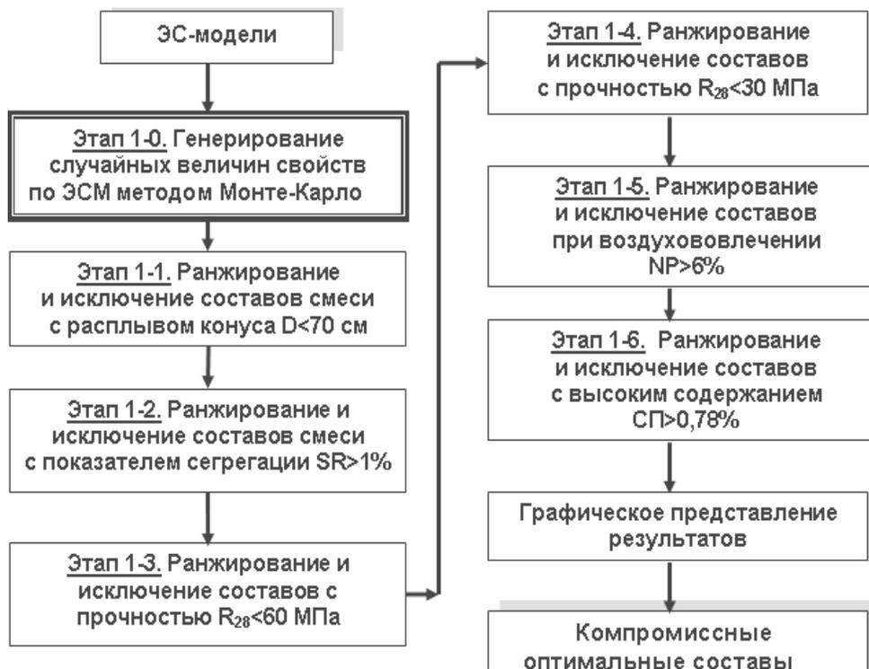
Рис.1. Схема процедуры итерации генерированных составов
