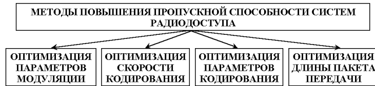
Рисунок1 – Классификация методов повышения пропускной способности СРД
