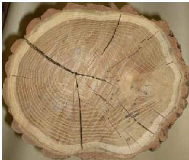
Рисунок 3 – Типичный вид торцевого среза высушенной на воздухе при комнатной температуре древесины, подвергшейся естественному процессу разрушения (раскалыванию) из-за своего радиального трещинообразования
