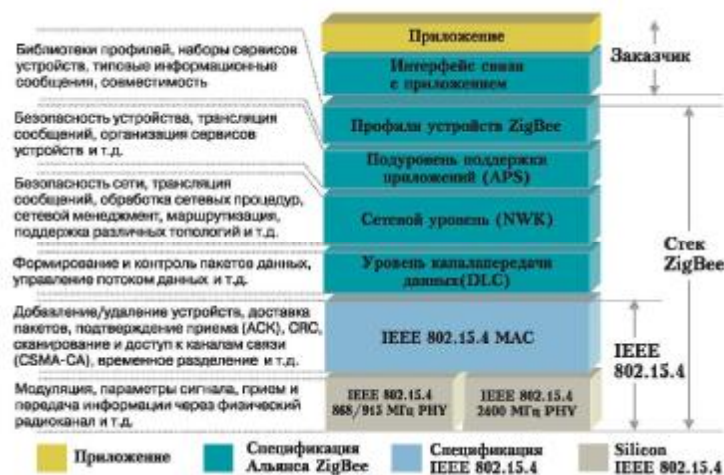
Рисунок 2 – Архитектура стека Zigbee/IEEE 802.15.4
