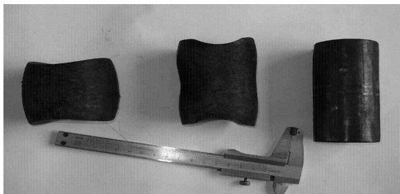
Рис. 2. Заготовки, осажённые выпуклыми продолговатыми плитами
