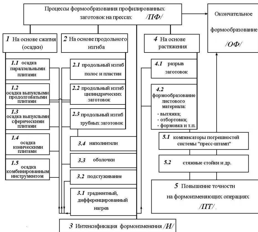
Рис. 1. Концепция бесштампового профилирования заготовок на прессах
