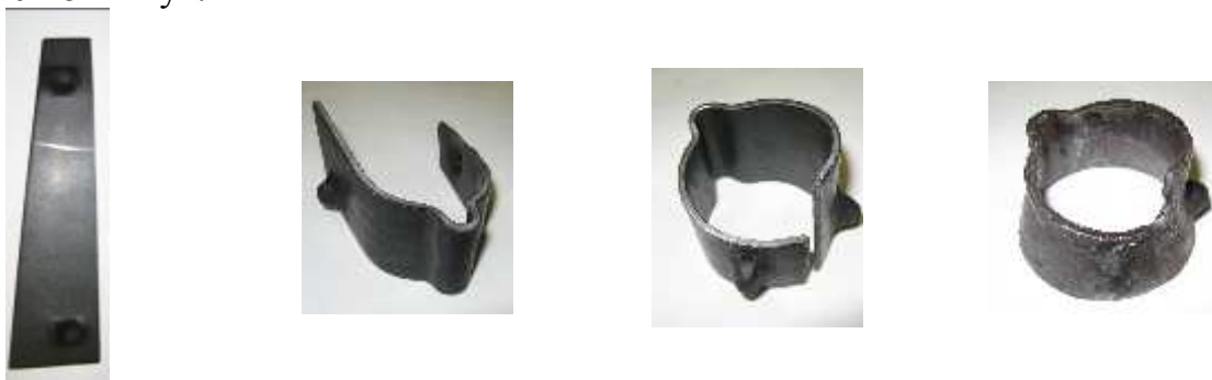
Рис.5. Технологический процесс изготовления верхней чашки
