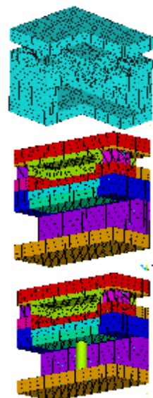
Рис. 3. Параметрические конечно-элементные модели пресс-форм, созданные в СПМК
