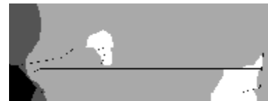
Рис. 5. Картина розподілу тиску при обтіканні МТ-ЛБ ударною хвилею у вертикальній серединній площині
