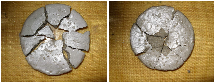
Рисунок 1 – Характер руйнування бетону: а – при дії імпульсу наносекундного діапазону; б – при дії імпульсу мікросекундного діапазону
