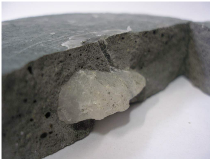
Рисунок 1 – Характер руйнування зразка з включенням кристалу (над кристалом у породі видно слід від каналу розряду)
