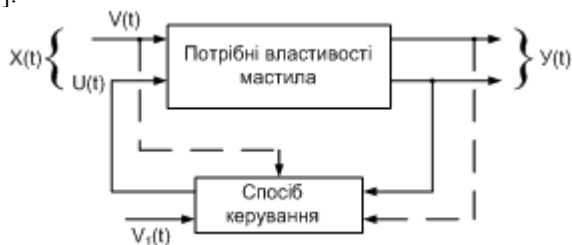
Рис. 2. Схематичне уявлення процесу керування властивостями мастильного матеріалу для підшипників кочення
