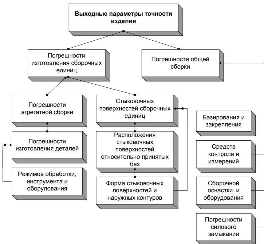
Рис. 7. Структурная схема формирования выходных параметров точности изделия
