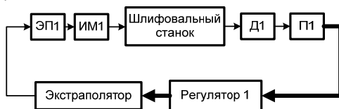
Рис. 1 - Структурная схема канала управления поперечной подачей шлифовального круга
