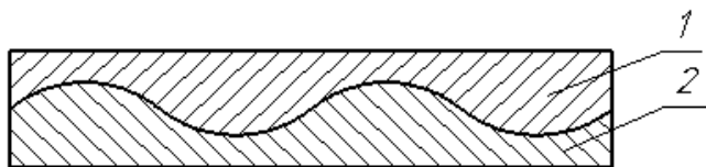
Рисунок 1 – Схема профілю леза зміцненого зносостійким матеріалом змінної товщини: 1 – зносостійкий шар; 2 – основний шар
