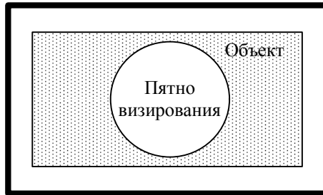
Рис. 3. Пятно визирования пирометра
