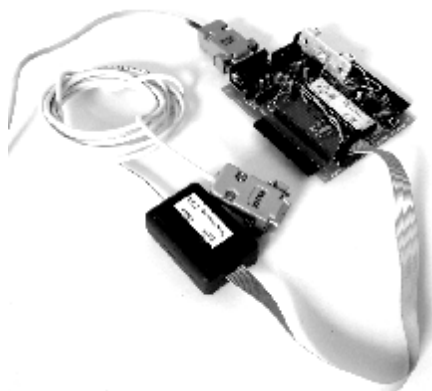
Рис. 4. Программатор и плата микроконтроллерного модуля программирования и связи с ПК
