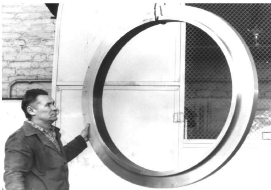
Рис. 6. Жесткое колесо волнового редуктора поворота миксера МП – 600АС
