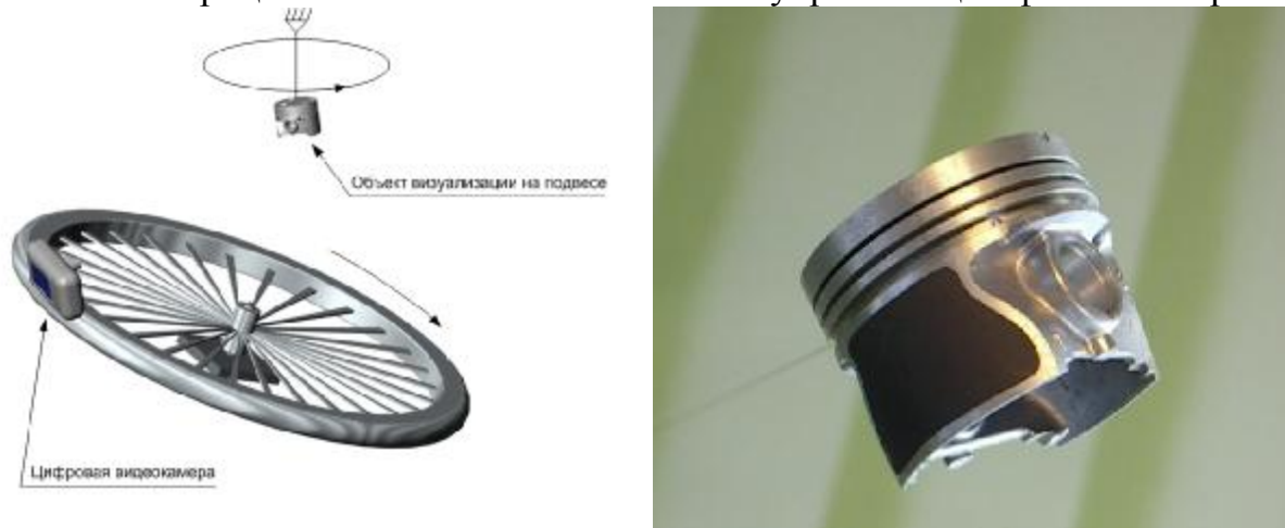
Рис.3 Модель процесса видеосъемки поршня и фрагмент полученного видеоматериала
