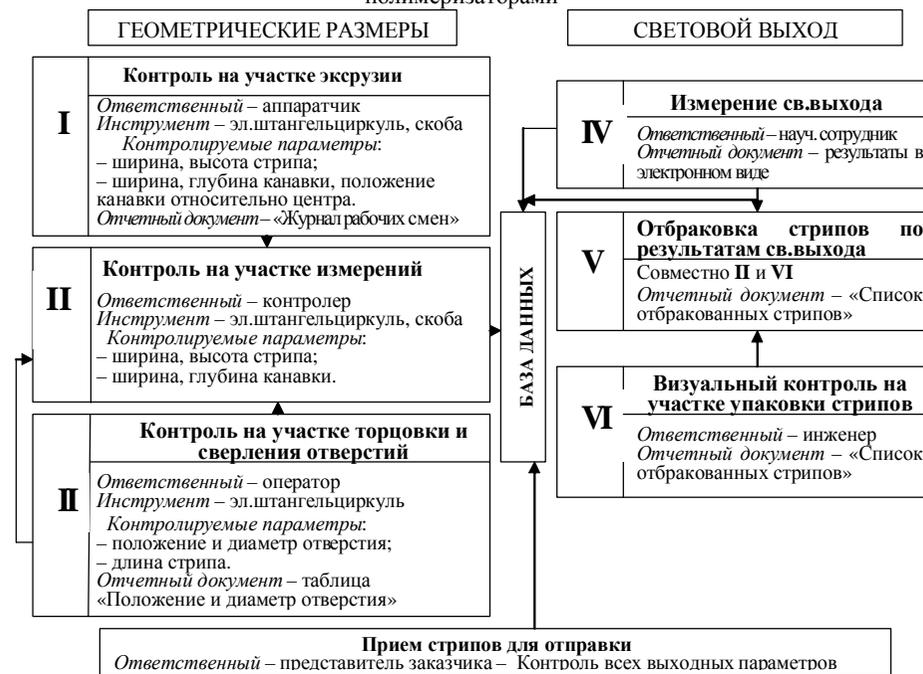
Рис. 4 – Система производственного контроля качества ПС стрипов
