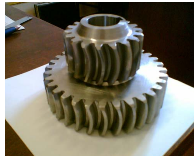
Рис. 8. Арочные зубчатые колеса
