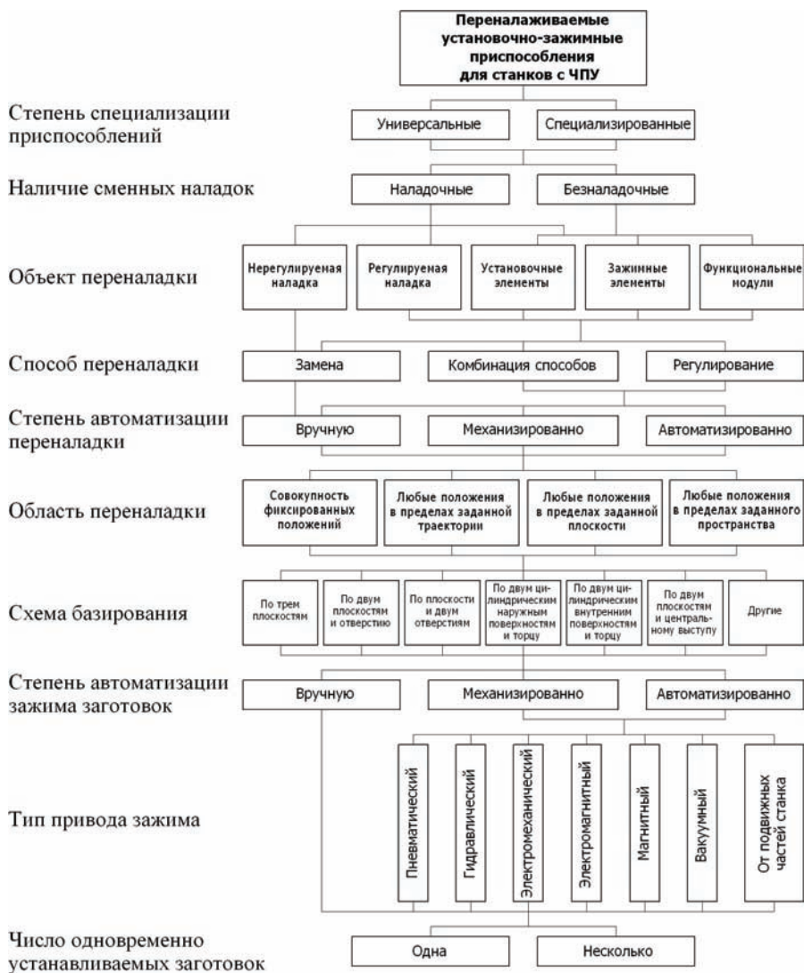
Рис. 3. Классификация перенастраиваемых установочно-зажимных приспособлений для станков с ЧПУ
