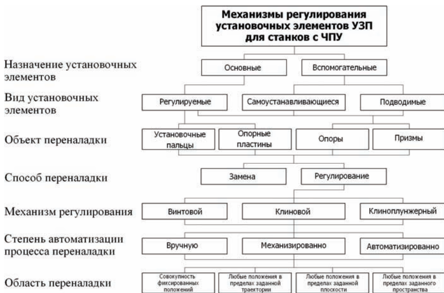
Рис. 5. Классификация механизмов регулирования установочных элементов УЗП для станков с ЧПУ
