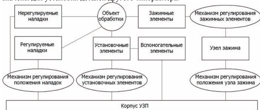
Рис. 4. Структура установочно-зжимного приспособления
