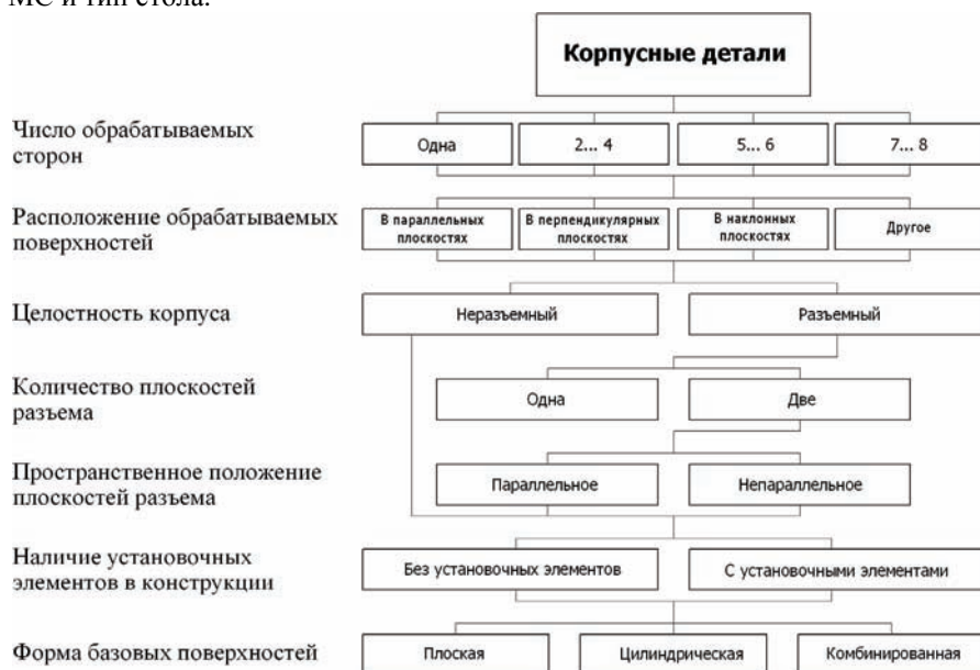
Рис. 2. Классификация корпусных деталей
