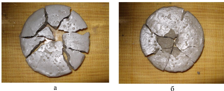
Рисунок 6 – Характер руйнування бетону: а – при дії імпульсу наносекундного діапазону; б – при дії імпульсу мікросекундного діапазону.
