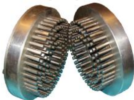
Рисунок 7 – Знаряджені бітами диски статора та ротора
