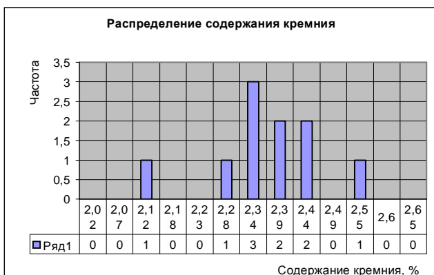
Рис. 1. Гистограмма распределения содержания углерода, марганца, кремния и серы в базовом чугуне, обработанном ферросилицием ФС-75
