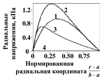
Рис. 4. Распределение радиальных напряжений в сосуде для \epsilon_{\max} = -0.1 для различных моментов времени: 1 – 0.001t_* , 2 – 0.01t_* , 3 – 0.1t_* , 4 – t_*
