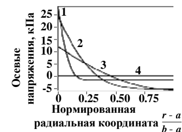
Рис. 6. Распределение осевых напряжений в сосуде с \epsilon_{\max} = -0.1 для различных моментов времени: 1 – 0.001t_* , 2 – 0.01t_* , 3 – 0.1t_* , 4 – t_*
