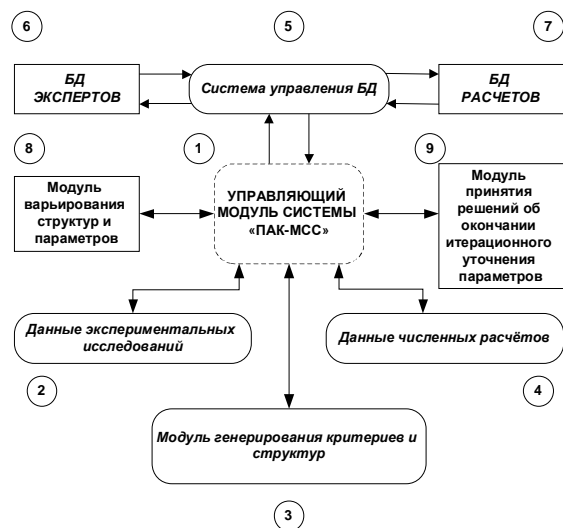
Рис. 3. Схема информационных потоков в создаваемом программно-аппаратном комплексе „ПАК-МСС”
