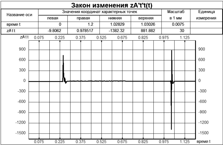
Рисунок 3 – Зависимость от времени ускорений точек нижнего торца КУ
