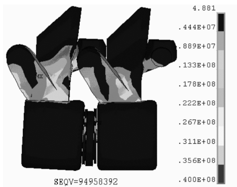
Рисунок 10 – Напряженное состояние модели с протезом, контактная задача
