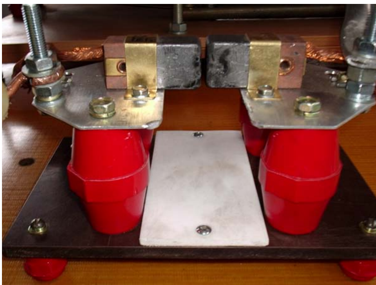
Рисунок 2 – Общий вид мощного высоковольтного малогабаритного воздушного двухэлектродного разрядника типа ММВР-5 на 5 кВ, обеспечивающего коммутацию разрядных цепей генераторов длительной и промежуточной составляющих полного тока молнии с переносимым ими суммарным электрическим зарядом не менее 210 Кл
