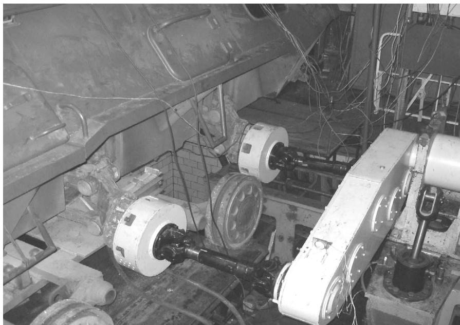
Рис.5. Подключение суммирующего редуктора к ступицам колёс задних мостов бронетранспортёра с помощью карданных валов и переходников
