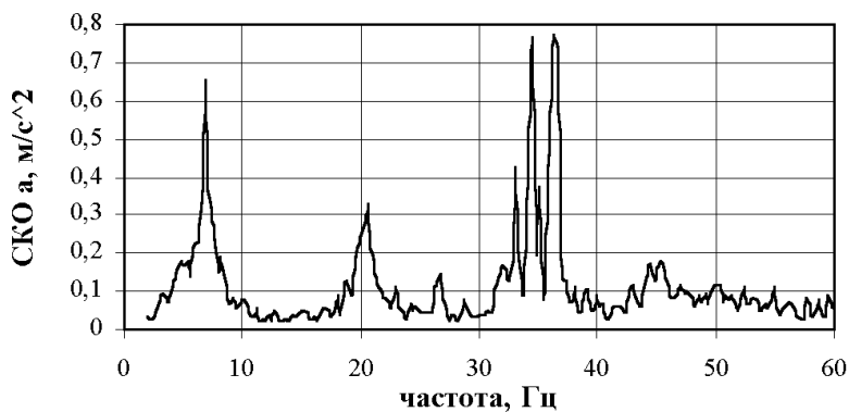
Рисунок 5 – СКО вертикальных ускорений, измеренных на раме тележки, для скорости 60 км/ч
