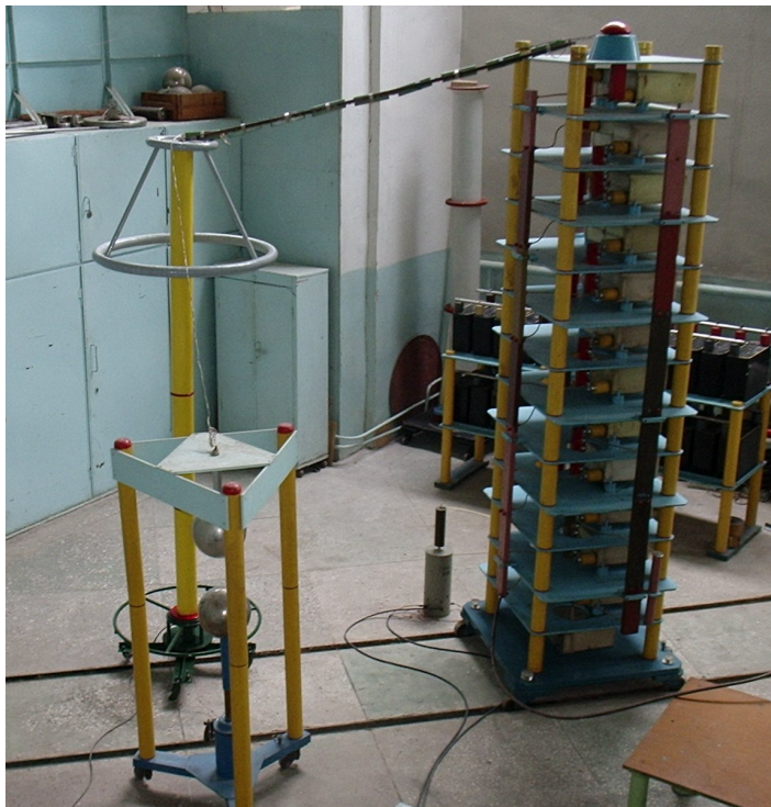
Рисунок 4 – Общий вид высоковольтной электроустановки с измерительными шарами \varnothing 250 мм для испытания передвижного омического делителя напряжения типа ОДН-1
